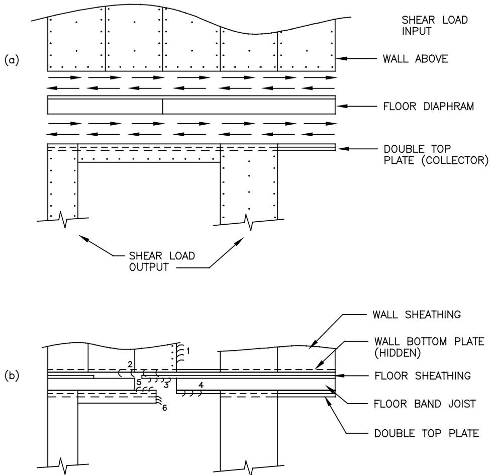
COMPOSITE FAILURE PLANE FOR A COLLECTOR:
