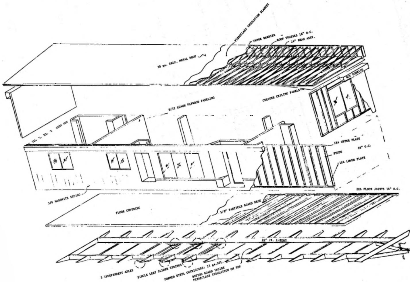
FIGURE 37. T-2B DOUBLE WIDE - EXPLODED ISOMETRIC
