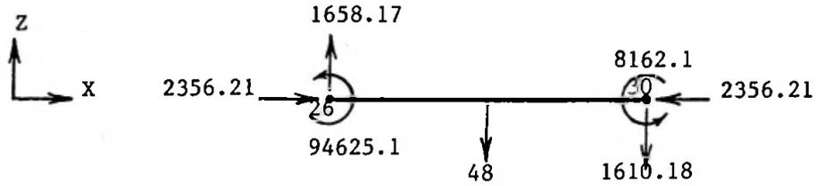
a.) X-Z Plane Freebody Diagram, Element 376
