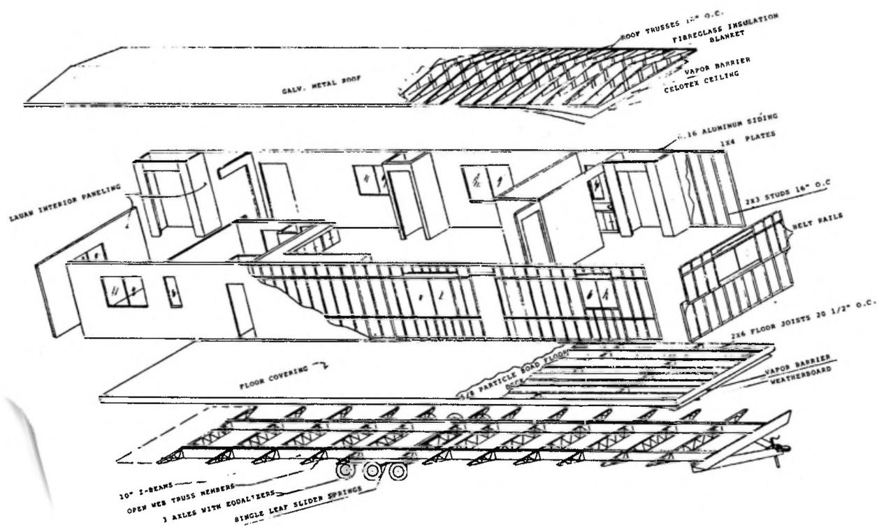
FIGURE 1. T-1 MOBILE HOME EXPLODED ISOMETRIC
