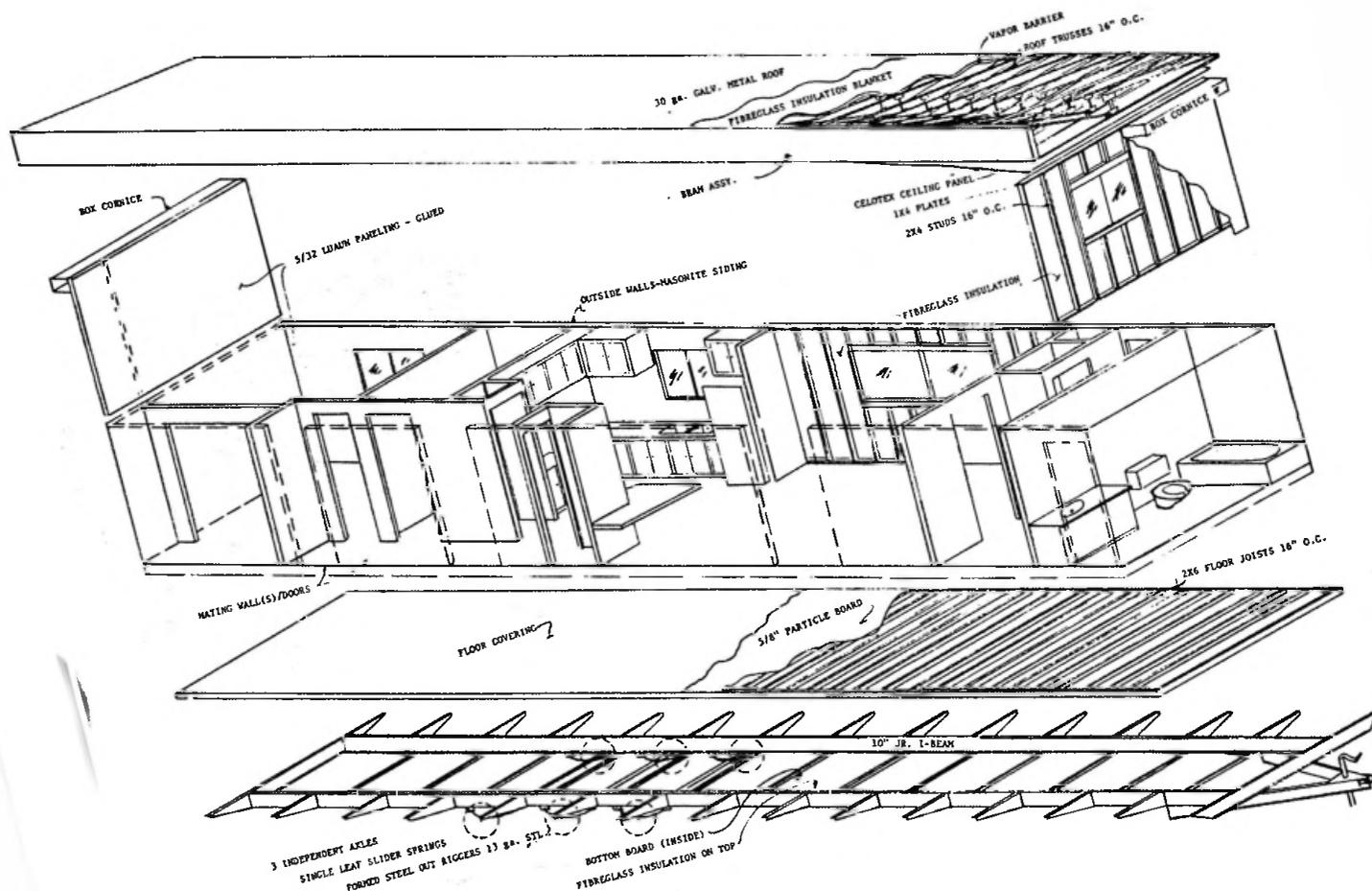
WET SIDE OF REDMAN DOUBLE WIDE 24X56 EXPLODED ISOMETRIC
