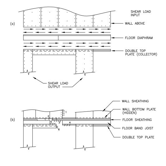
COMPOSITE FAILURE PLANE FOR A COLLECTOR:
