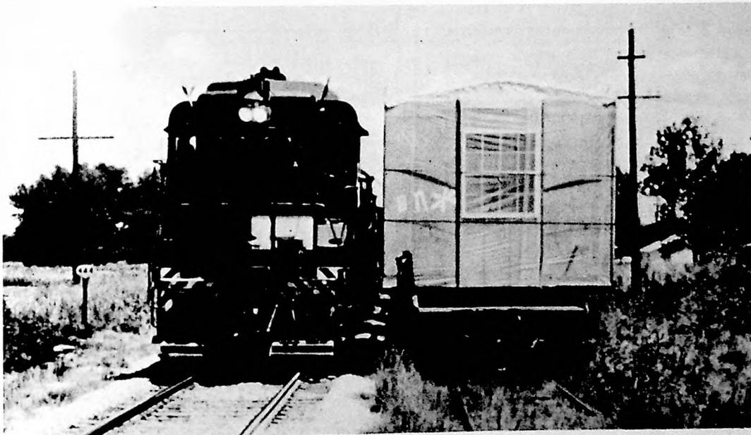
PHOTO SHOWING CLEARANCE BETWEEN MODULE ON FLAT CAR AND LOCOMOTIVE ON ADJACENT TRACK
