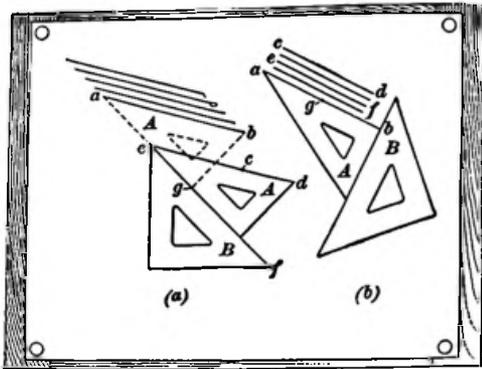
FIG. 10. USE OF TRIANGLE FOR PARALLEL LINES
