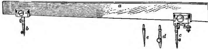
FIG. 28. BEAM COMPASS
