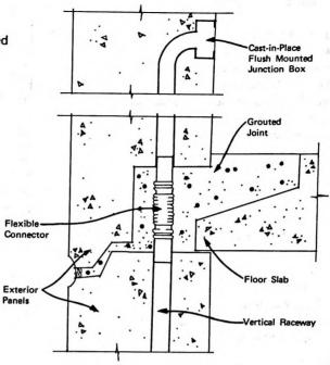
FIGURE 7.1a TYPICAL STRAIGHT RUN CONNECTOR
