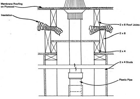
FIGURE 9.3a LEVITT-PLASTIC DOWNSPOUT IN MECHANICAL CHASE
