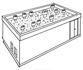
FIGURE 5.6a PRE-PACKAGED MECHANICAL PENTHOUSE
