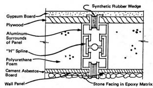
FIGURE 2.10 g PANTEK- VERTICAL WALL PANEL JOINT
