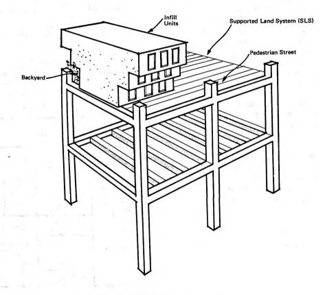
FIGURE 1.8 MEGASTRUCTURE AND TYPICAL INFILL UNIT
