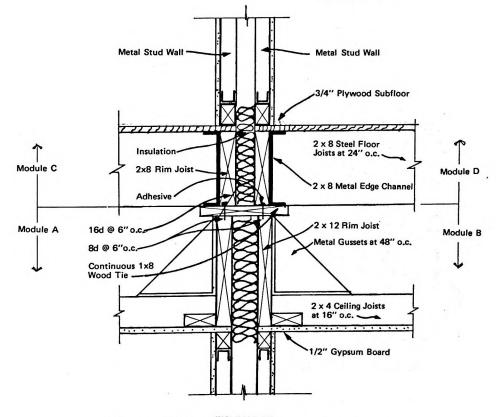
FIGURE 2.12j NATIONAL HOMES- INTERIOR MODULE TO MODULE JOINT
