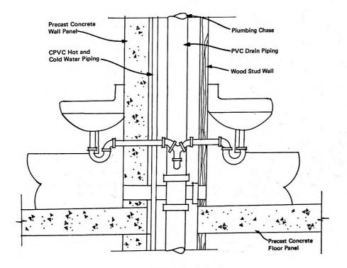
FIGURE 9.4 TYPICAL PLUMBING CHASE UTILIZING PLASTIC PIPE
