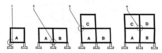
FIGURE 2.12a TYPICAL STACKED MODULE ERECTION SEQUENCE
