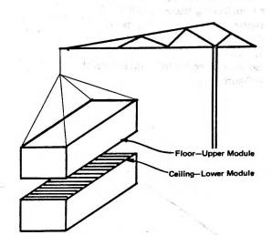
FIGURE 1.4a ERECTION OF MODULES
