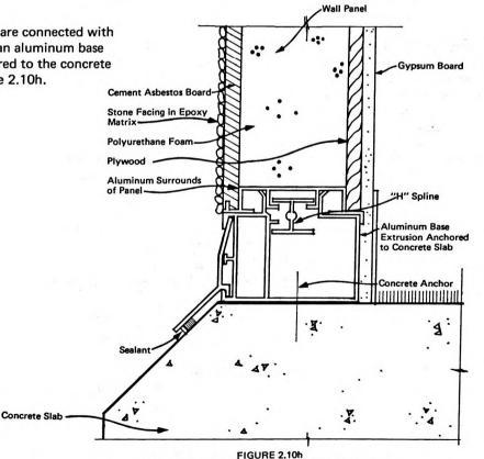
PANTEK-EXTERIOR WALL PANEL TO SLAB JOINT
