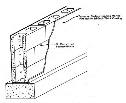
FIGURE 2.13 SURFACE BONDED FOUNDATION WALL
