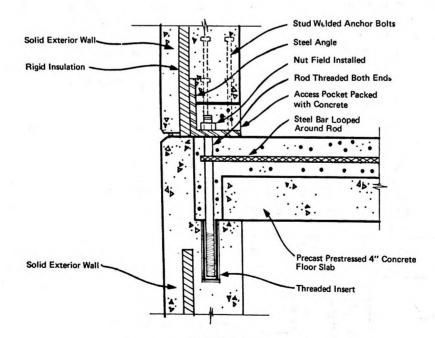
FIGURE 2.15f FCE-DILLON- EXTERIOR BEARING WALL DETAIL
