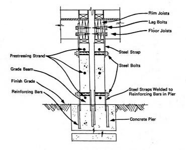
FIGURE 2.14b GRADE BEAM CONNECTION DETAILS
