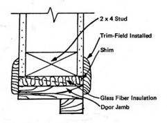
FIGURE 4.1a FCE DILLON-FIRE STOPPING AROUND DOORS
