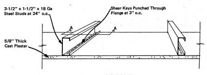
FIGURE 3.15a CAST PLASTER/STEEL STUD PANEL
