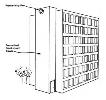
FIGURE 4.2 ROUSE WATES-PRESSURIZED SMOKEPROOF TOWER
