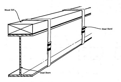
FIGURE 2.11 SILL PLATE ATTACHMENT TO STEEL BEAM
