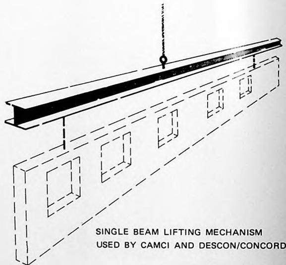
**SINGLE BEAM LIFTING MECHANISM
