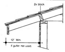
Figure 28. Open Soffit
